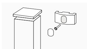
**Poste H:** Para fixação dos painéis na vedação. Inclui tampa, abraçadeira e parafusos auto-perfurantes.
